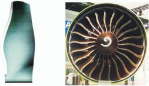
图 2 GE90-115B 发动机带后掠的风扇叶片
