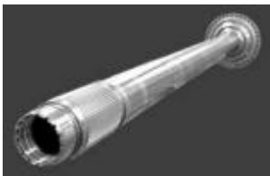
图 12 低压涡轮前轴
