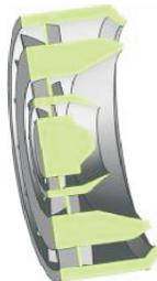
图11 旋流器几何结构(剖视)
