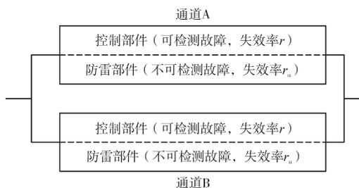
图1 双通道FADEC简化模型
