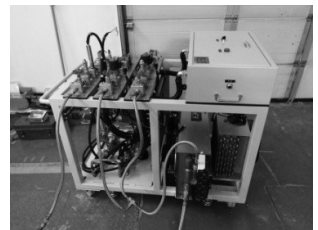
图5 冷却气源系统实物
