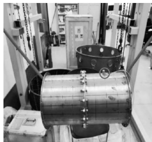
图4 圆筒试验件边界条件
