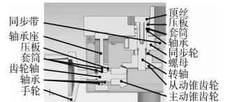
图8 同步升降机构输入端
